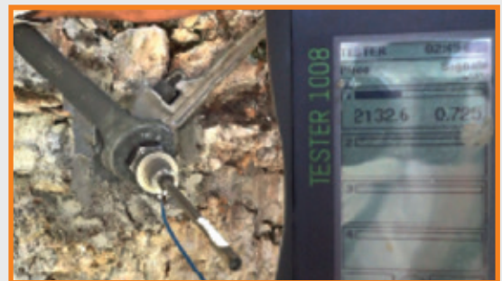
Précontrainte du micro-ancrage
