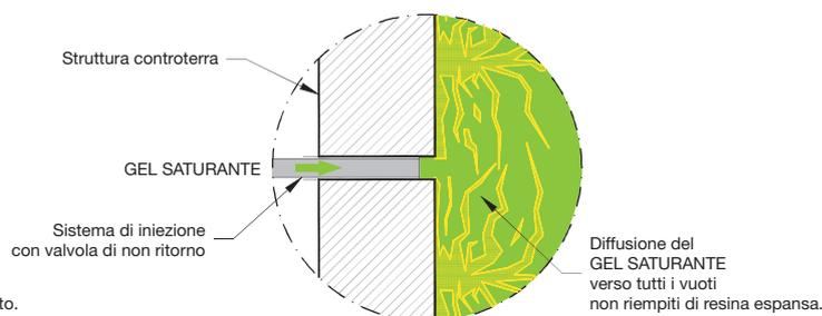
**IL RISULTATO È IL TOTALE E DEFINITIVO ISOLAMENTO DALLE INFILTRAZIONI DI ACQUA DALL'ESTERNO.**
