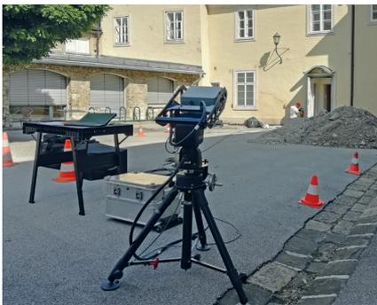
Quelques «injections de calibrage» sont ensuite réalisées en certains points dans le volume de sol à traiter. Celles-ci ont lieu jusqu'à l'apparition d'un premier léger relèvement du bâtiment (de l'ordre de grandeur du dixième de millimètre). La résine liquide s'étend et le sol injecté atteint un degré de compression et de compaction non seulement supérieur à la charge qui se trouve au-dessus, mais également même à celui qui se développe lors du relèvement.
