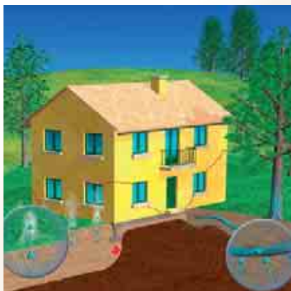
Essiccamento degli strati superficiali del terreno dovuto alla siccità o alla presenza di piante con apparato radicale molto esteso.
