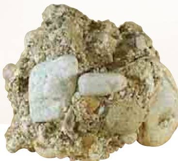
Campione di terreno sabbioso-ghiaioso trattato con resina Geoplus®.
