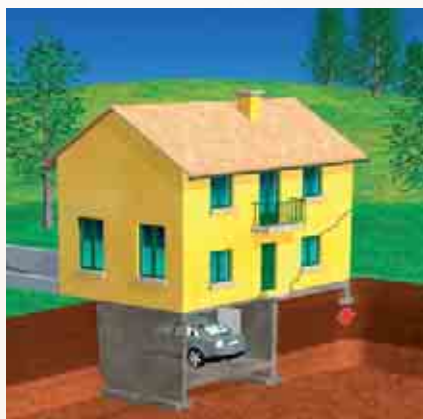
Diversità nella dimensione e profondità della fondazione in differenti aree dell'edificio.
