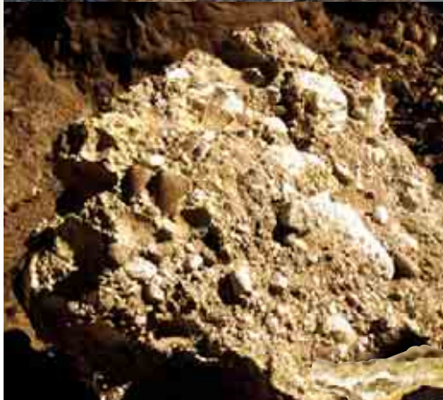
Campione di sabbia trattato con resina Geoplus®.
