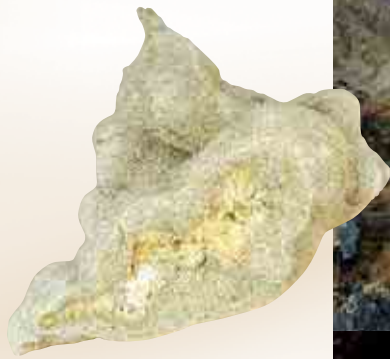
Campione di sabbia trattato con resina Geoplus®.
