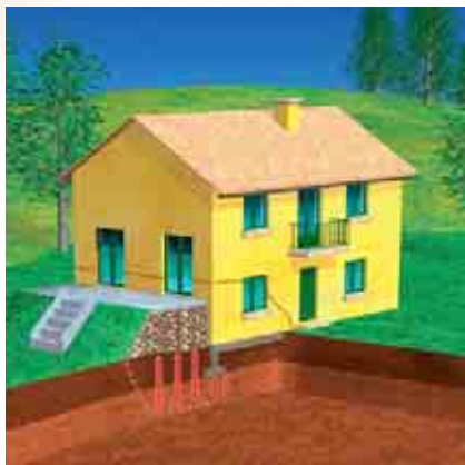
Presenza di terreno riportato e sovraccarichi concentrati su porzione dell'edificio.
