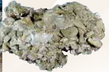
Campione di terreno sabbioso-ghiaioso trattato con resina Geoplus®.
