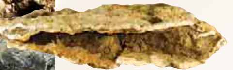
Campione di terreno limoso-argilloso trattato con resina Geoplus®.
