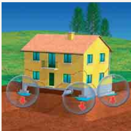
Rottura di tubazioni, condotti fognari, etc.
