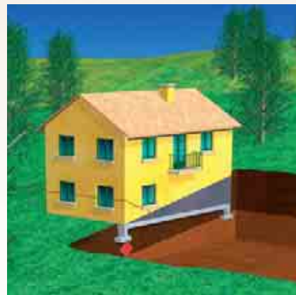
Diversità dell'addensamento del terreno di fondazione in edifici costruiti a mezza costa.
