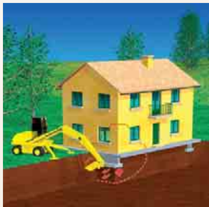
Scavi affiancati al fabbricato.
