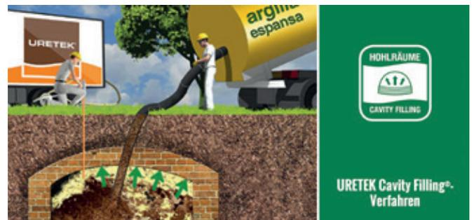
Mit dem **URETEK Cavity Filling®**-Verfahren werden unter- und oberirdische Räume verfüllt.
