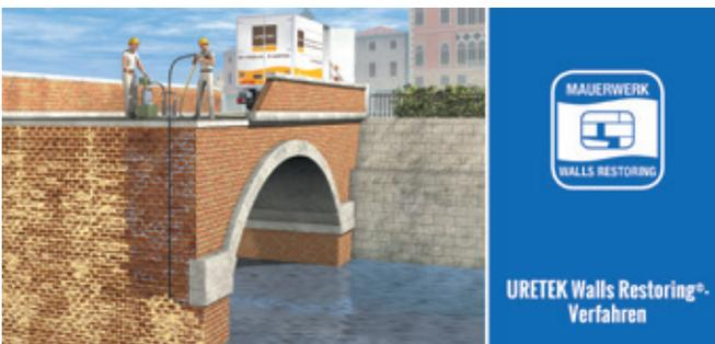
Mit dem **URETEK Walls Restoring®**-Verfahren wird der Mörtelverbund von unterschiedlichstem Mauerwerk wiederhergestellt.
