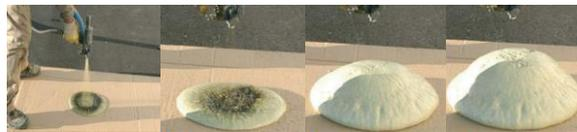
Figure 2.1. Séquences de la réaction de polymérisation
