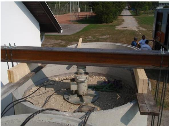
Figura 3, Piastra di carico con elementi portanti
