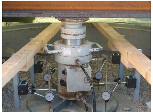
Figura 4, Cilindro idraulico e piastra di carico con dispositivi a comparatore
