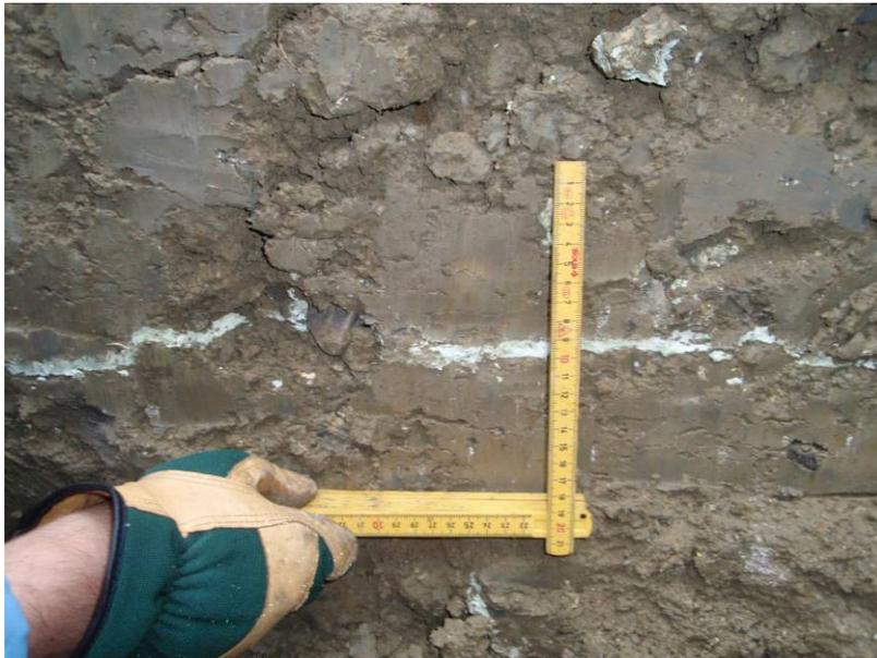
*Figura 12, espansione del materiale di iniezione nel tegel*
