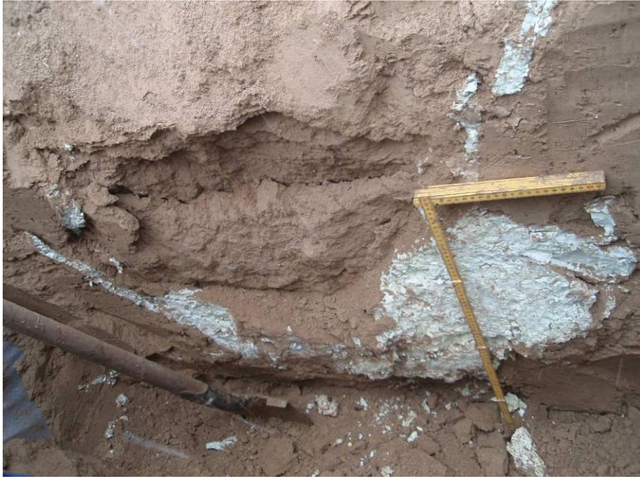
*Figura 18, espansione della resina nell'area circostante il punto di iniezione*
