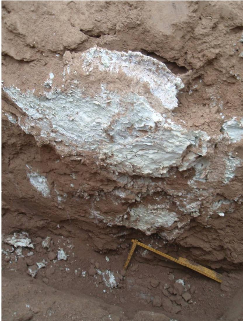
*Figura 17, espansione della resina nell'area circostante il punto di iniezione*
