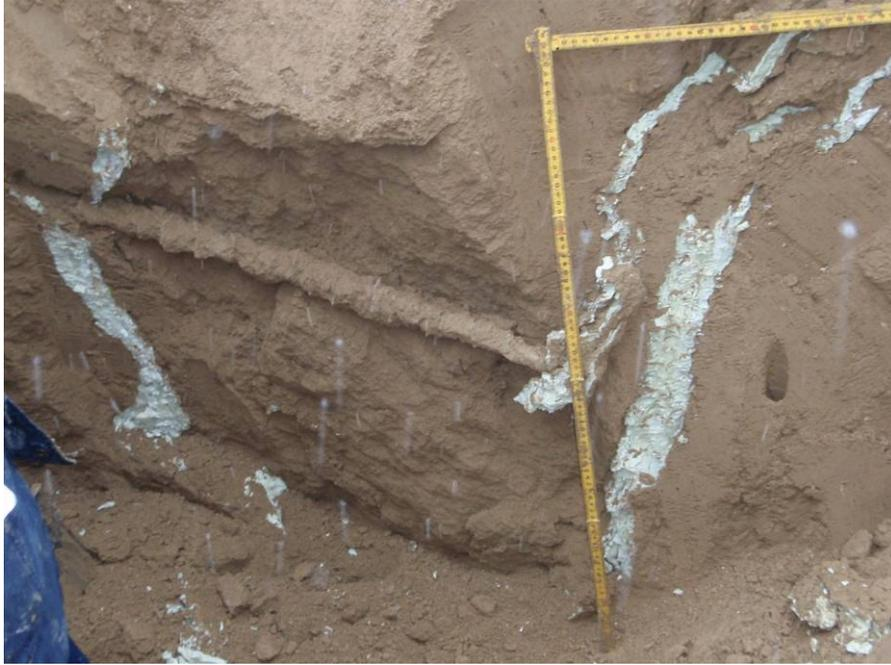
*Figure 19, expansion du produit dans l'aire environnant le point d'injection*
