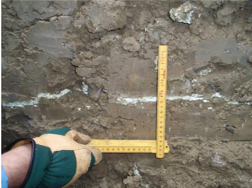
*Figure 12, expansion du matériel d'injection dans le Tegel*
