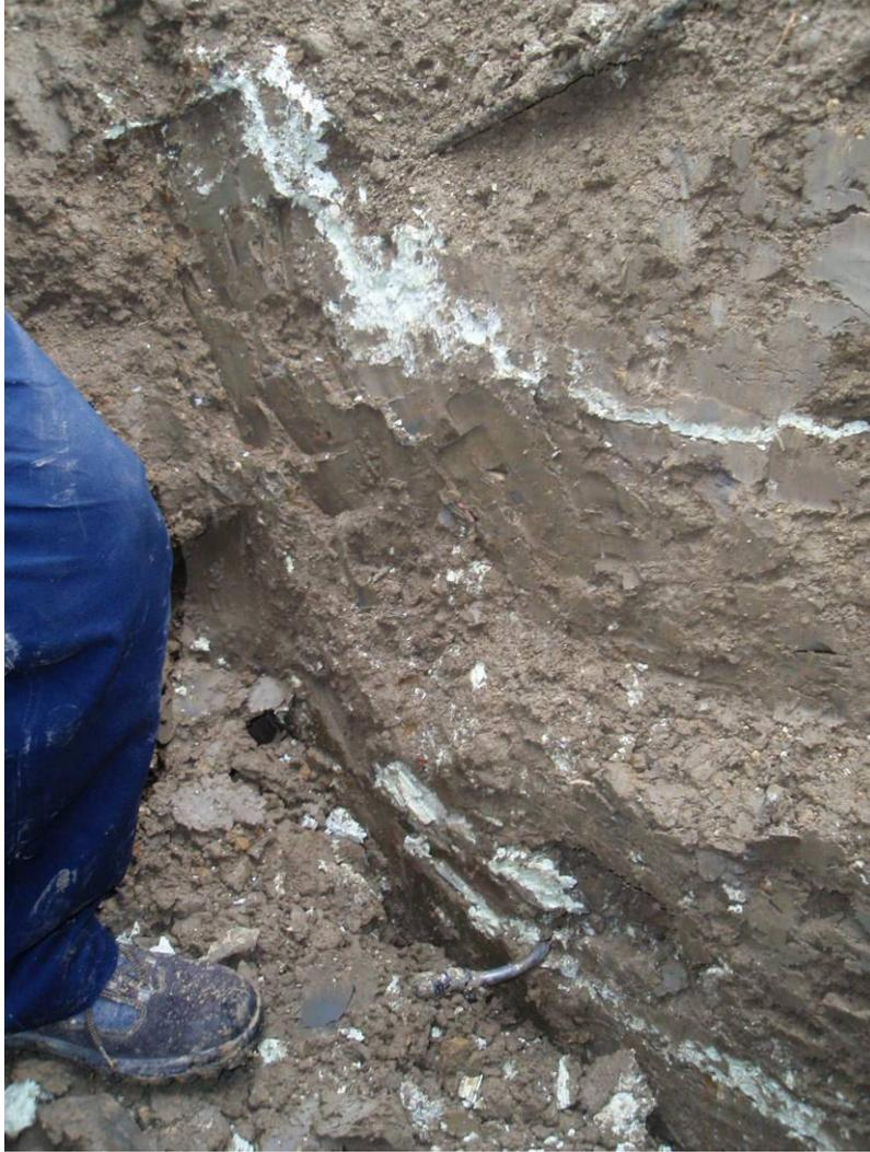
*Figure 14, expansion du matériel d'injection dans le Tegel*
