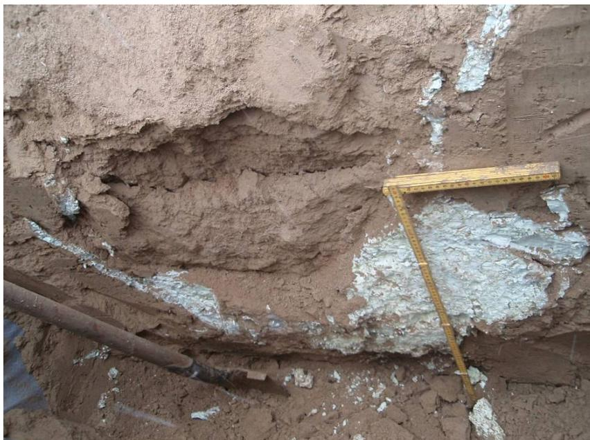
*Figure 18, expansion du produit dans l'aire environnant le point d'injection*
