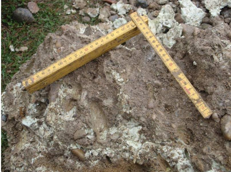
*Figure 7, mélange de gravier et résine Uretek Geoplus®*
