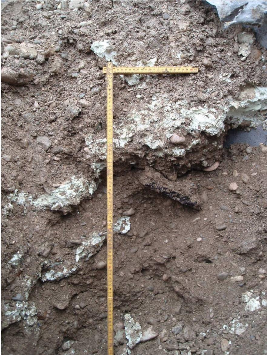
*Figure 9, expansion de la résine dans le gravier*
