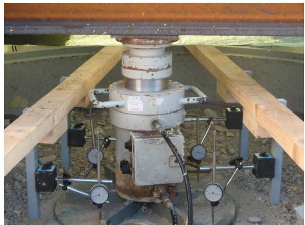
Figure 4 Plaque de charge et plaque de charge avec des dispositifs à comparateur
