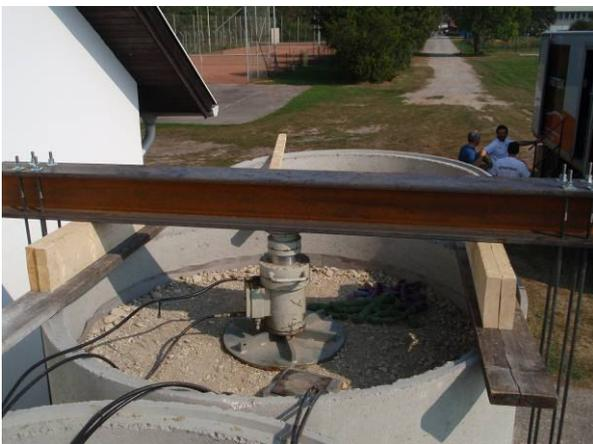
Figure 3 Plaque de charge avec des éléments portants
