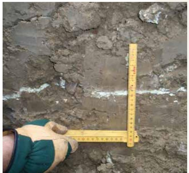
La pénétration de la résine est variable: remplissage des fissures de retrait, claquage et compactage
