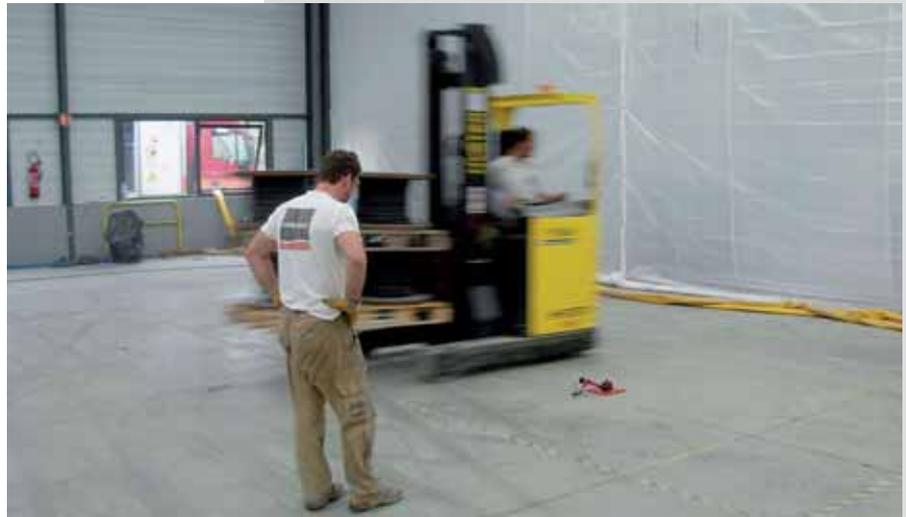
Contrôle des oscillations du sol lors du déplacement d'un chariot élévateur, à l'aide d'un comparateur.
