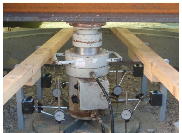
Abbildung 4, Belastungszyylinder und Lastplatte mit Messuhren
