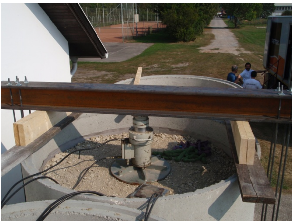
Abbildung 3 Belastungszyylinder mit Widerlager
