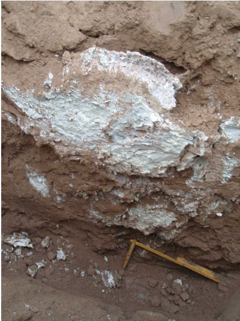
Abbildung 17, Ausbreitung des Injektionsgutes im Bereich der Injektionsstelle
